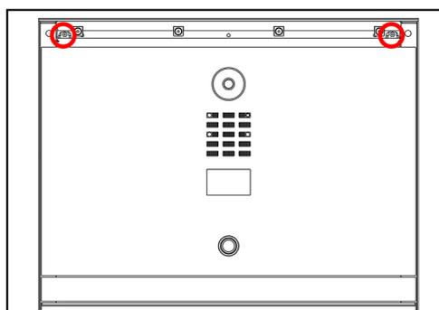
Die Verschraubungen sind nun zugänglich. Lösen Sie die beiden Sicherheitsschrauben links und rechts, mit den kleinen mitgelieferten orangenen Schraubendreher. Tipp: die Schrauben sind etwas weiter nach hinten versetzt. Die 4 Magnete müssen nicht gelöst werden.
