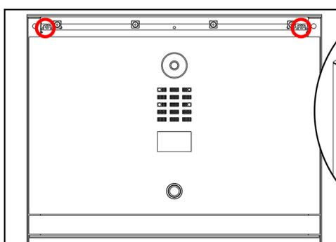
Nach Anschluss, die Schublade schließen und die Sicherheitsschrauben wieder eindrehen.
