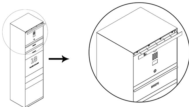
Dafür muss als erstes die oberste kleine Blende abgenommen werden. Die Blende ist magnetisch um die Verschraubungen der Schublade zu verdecken und somit zusätzlichen Schutz der Technik zu gewährleisten. Nehmen Sie die Blende mit Hilfe des mitgelieferten Hakenmagneten ab. Dabei darauf aufpassen, dass die Blende nicht herunterfällt!
