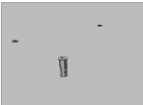
Mitgelieferte Dübel in die Bohrlöcher setzen.
