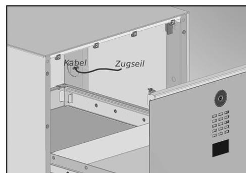
Wir haben für Sie bereits ein Zugseil in das Rohr für die Kabelführung gelegt. So können Sie das Anschlusskabel leichter hoch in den Funktionskasten ziehen. Ziehen Sie das Anschlusskabel, dass Sie zuvor unten am Fuß an dem Zugseil befestigt haben nach oben in die Box.
