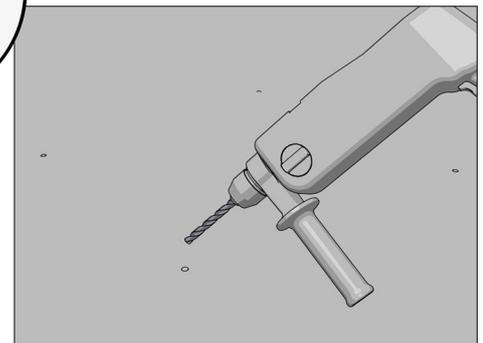
Bohrlöcher an gekennzeichneten Stellen bohren.
